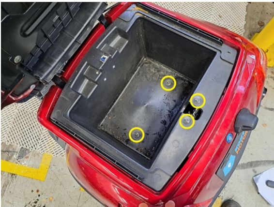
Irrota säilytyskotelon kiinnityspultit. (hylsy 8 mm).
