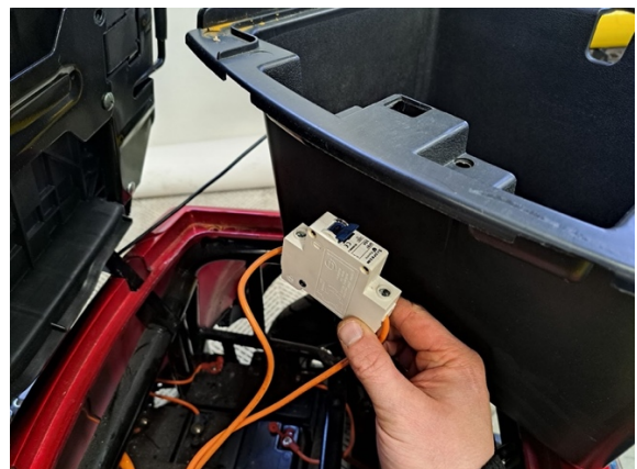
Ota päävirtakytkin pois ja siirrä säilytyslokero pois.
