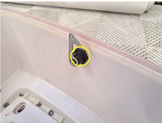
Irrota takalaukun lukon muovinen kiinnitysmutteri.
